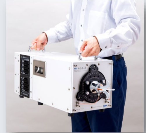
4～40GHz 水平・垂直両偏波 デジタルマイクロ波放射計
