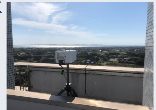
千葉県富津市の建物屋上に DS \mu RADを設置し東京湾を計
