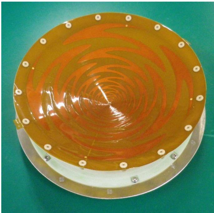
アンテナ1個で1~41GHzに渡る情報を収集し、装置に入力
